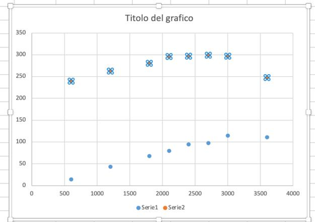
Rampa per determinare il voltaggio di lavoro sul catodo:
