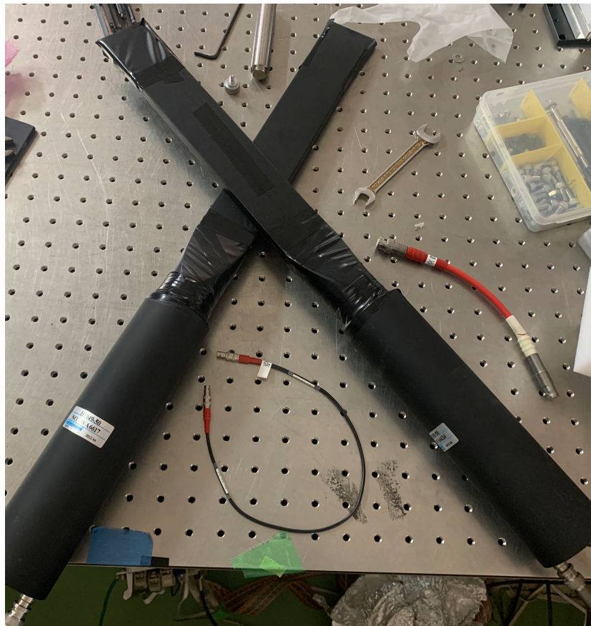
図 4.5 宇宙線を用いた同期回路の動作試験のセットアップの様子: 2つのプラスチックシンチレータを重ねて配置している。
